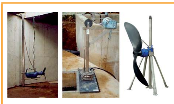
Figura 3.31: AMS com hélice (esquerda), tubulação guia (centro), grande pá (direita) [Agrartechnik Lothar Becker (esquerda, centro), KSB AG]
